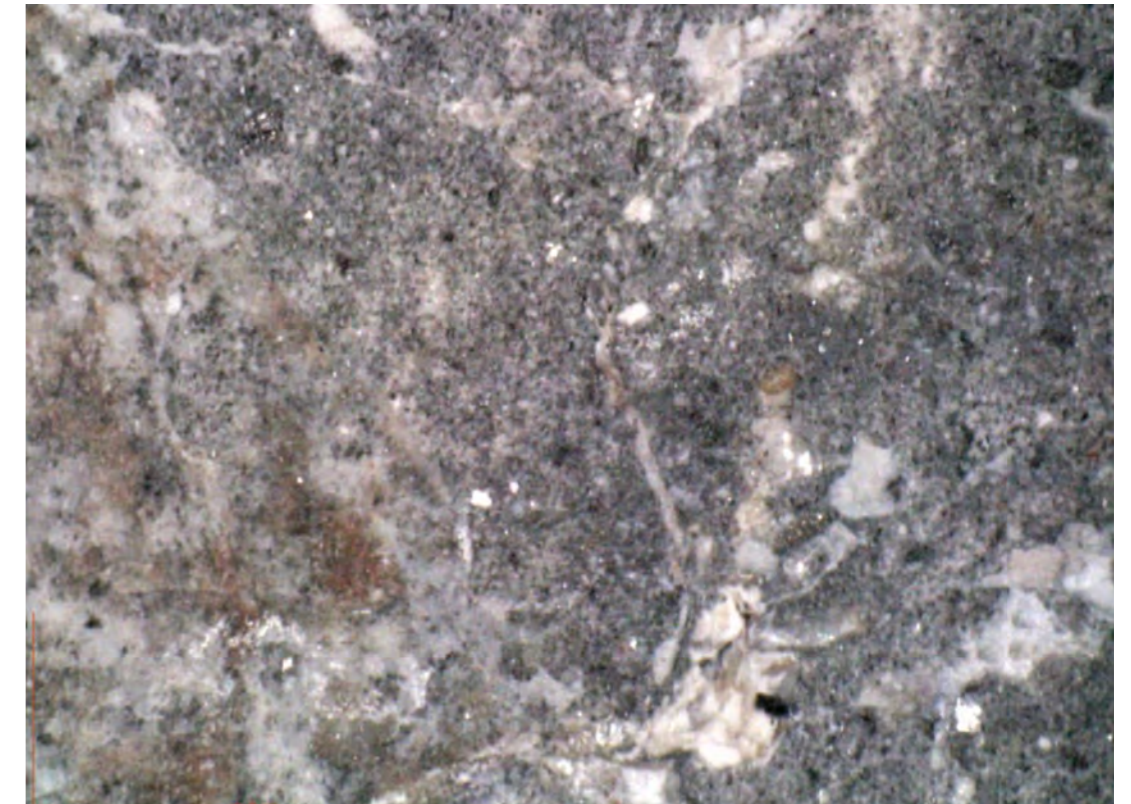
Abb. 16: Versuchsfläche 031, Mikrofoto: gleicher Ausschnitt wie Abb. 15. Im unpolarisierten Licht ist der unregelmässige Farbabtrag kaum auszumachen – die Fläche wirkt, als ob noch überall etwas Tünche auf der Malschicht verblieben sei.
