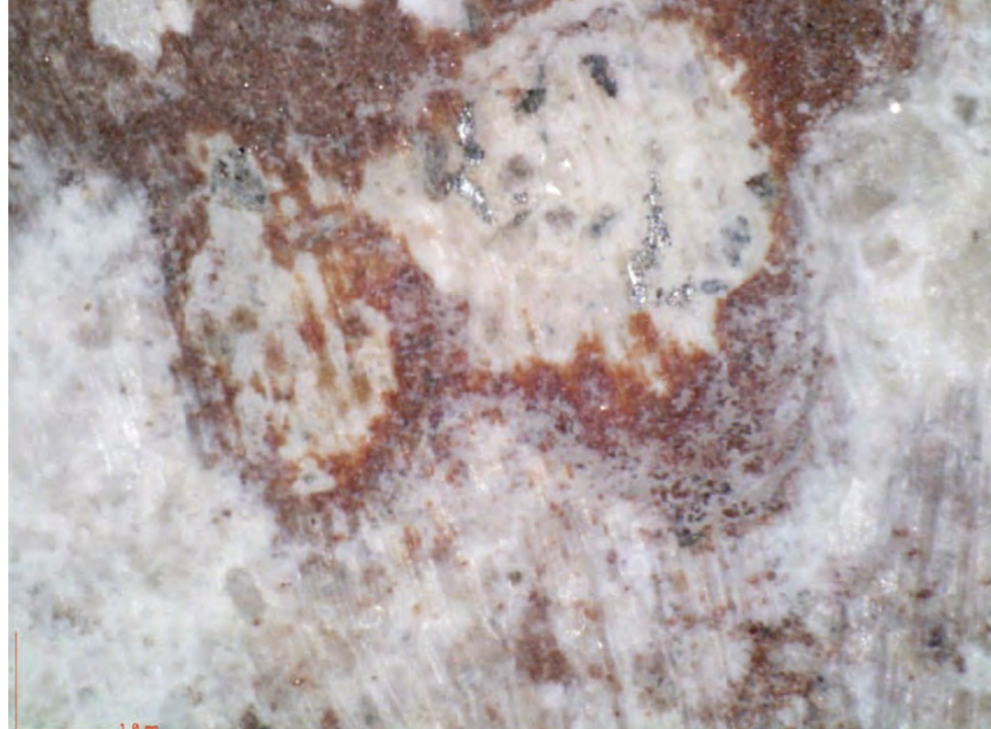
Abb. 9: Versuchsfläche 011, Mikrofoto: durchgeschliffene Malschicht und Abrieb von Fremdmaterial in den Poren der Oberfläche (Metallabrieb der Bürstenköpfe)
