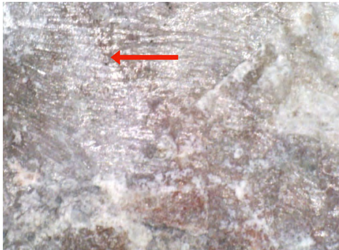
Abb. 21: Versuchsfläche 033, Mikrofoto: gleicher Ausschnitt wie Abb. 20 polarisiert. Im unpolarisierten Licht sind die Spuren des Lasers kaum sichtbar, dafür dominieren die Polierspuren der vorgängigen Bürstenfreilegung.
