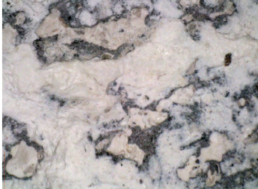
Abb. 6: Versuchsfläche 002, Mikrofoto: zeigt eine reliefartige Abtragung und eine leicht polierte, glänzende Oberfläche der bearbeiteten Tünche
