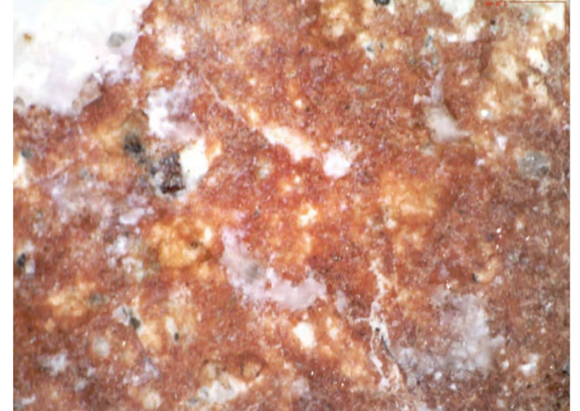
Abb. 11: Versuchsfläche 015, Mikrofoto: Die gut erkennbaren, punkt- und ringförmigen Abtragespuren des Lasers sind in diesem Foto noch deutlicher zu sehen, ebenfalls die unregelmässig dicken Reste der Kalktünchen auf der roten Malschicht.
