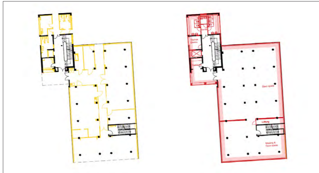
Abb. 15: Modernisierungsbedingte Eingriffe in Bau 27 (vgl. [2])
