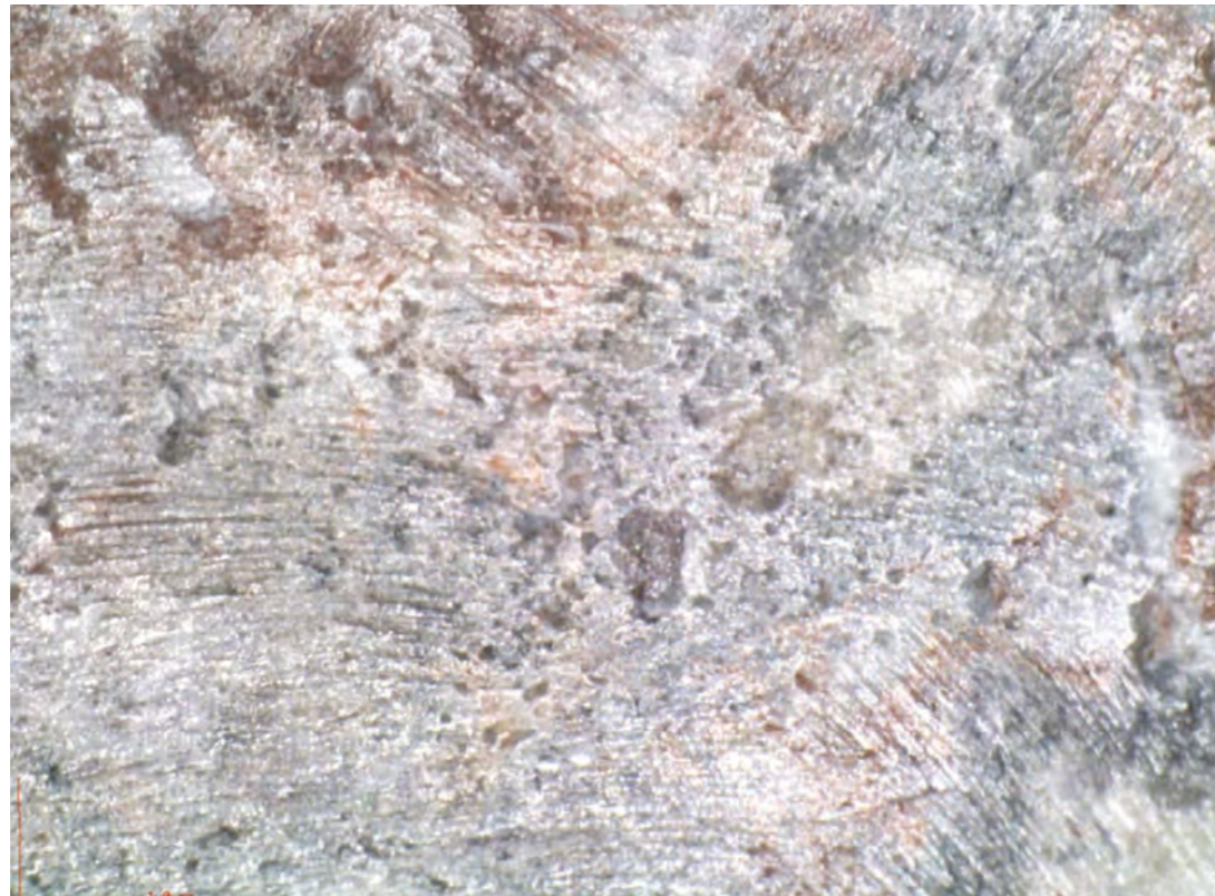
Abb. 14: Versuchsfläche 017, Mikrofoto: gleicher Ausschnitt wie Abb. 13. Im unpolarisierten Licht sind die Schleifspuren der vorbereitenden Abtragung der dicken Kalktünche als dicht glänzende Oberfläche zu erkennen.
