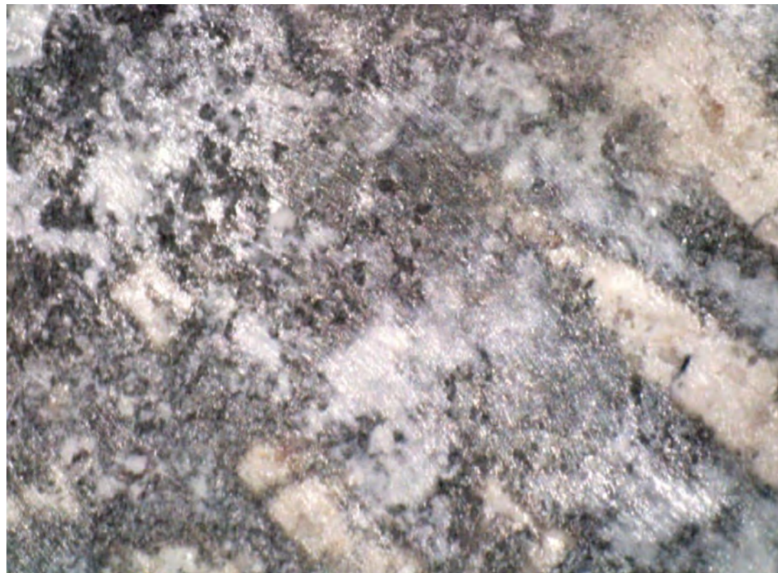
Abb. 7: Versuchsfläche 003, Mikrofoto: Schleifspuren vom vorrangigen Dünnen mit einem Schleifgerät mit rotierendem Bürstenkopf
